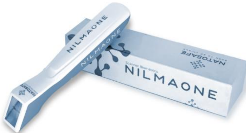
Figura 4 – Dispositivo de captura biométrica utilizado - Nilmaone® 3.250 dpi de resolução - certificação FAP 30 do FBI.
